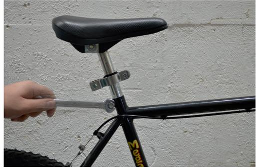
2. Schieben Sie die Sattelstange wieder ins Rahmenrohr ein. Richten Sie den Sattel in der gewünschten Höhe aus und ziehen Sie die Verklebung wieder fest.
