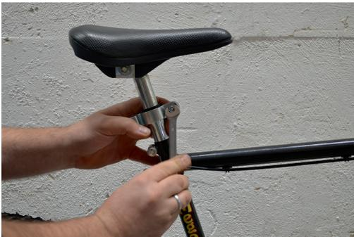
3. Schieben Sie die Fahrradkupplungshalterung in die gewünschte Position. Montieren Sie Schraube, Unterlegscheibe und selbstsichernde Mutter und ziehen Sie diese fest an. Schraube kontern.
