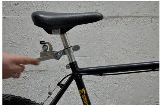
4. Montieren Sie die Kupplung mittels Schraube, Unterlegscheibe und selbstsichernder Mutter am Halter. Richten Sie die Kupplung waagrecht aus und ziehen Sie die Mutter fest an. Schraube kontern.
