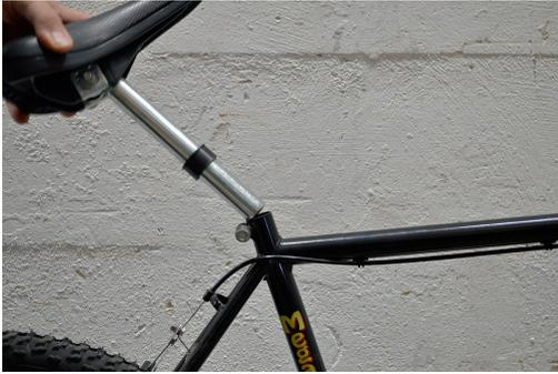
1. Lösen Sie die Verklebung des Sattels und ziehen Sie die Sattelstange aus dem Rahmenrohr heraus. Schieben Sie die schwarzen Kunststoff-Passringe auf die Sattelstange auf und die Fahrradkupplungshalterung darüber.
